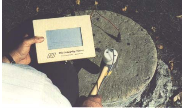
Figura 5 Prueba de Integridad del Pilote (PIT)
